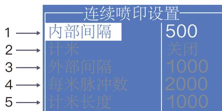
1. 此项设置每条信息之间的喷印间隔，越大则两条信息之间的间隔越宽，范围3-10000，如果还是不够用，可以将 **划速率倍率** 菜单内的 **内部间隔倍率** 增大；
